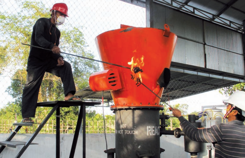
Le gazogène de 11 kW./The 11-kW gasifier.
